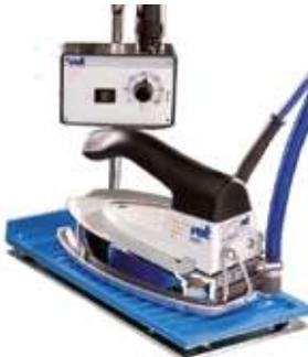
Durch die spezielle Ausformung des Unterschuhs kann ein Hosenbein in einem Pressvorgang gefiniert werden. Das Bezugssystem und die variable Druckeinstellung vermeiden unnötige Abdrücke.
