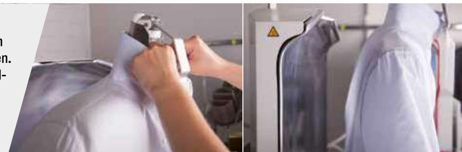
Die VEIT 8900 Hemdenpresse verfügt über eine pneumatische Höhenverstellung der Ärmelspanner. Dies verbessert das Ergebnis und die Qualität. Das lästige Nachbügeln entfällt.
